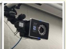
三次元動作解析装置 Vicon Vantageカメラ
